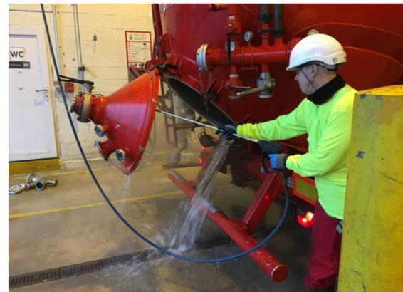
E78 Lavage à l'eau sous haute pression des orifices d'ouverture de remplissage et de vidange, pourtours compris, couvercles et toutes pièces jointes
